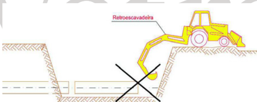
FIGURA 23. Exemplificação de como NÃO deve ser realizado o encaixe dos tubos
